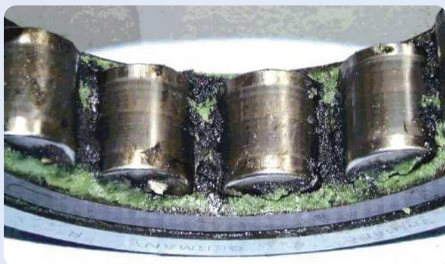
Verschmutzter Schmierstoff durch Funkenerosion
