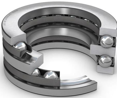
Zweiseitig wirkende Axialkugellager nehmen Axialbelastungen in beiden Richtungen auf, dürfen aber keiner Radialbelastung ausgesetzt werden. Ihre nicht selbsthaltenden Komponenten erleichtern den Ein- und Ausbau und die Instandhaltungskontrolle. Viele Komponenten sind austauschbar. Die Wellenscheiben haben eine geschliffene Bohrung, um eine feste Passung zu ermöglichen.
