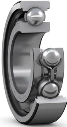
Einreihige Rillenkugellager sind besonders vielseitig einsetzbar, arbeiten reibungsarm, sind für einen niedrigen Geräusch- und Schwingungspegel optimiert und dadurch für hohe Drehzahlen geeignet. Sie nehmen Radial-Axial-Kombibelastungen in beiden Richtungen auf, lassen sich einfach montieren und sind weniger wartungsintensiv als viele andere Lagerarten.
