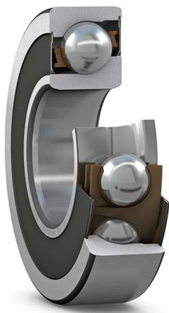
Roulement à billes à contact oblique à une rangée avec angle de contact de 40° et joints non frottants des deux côtés
