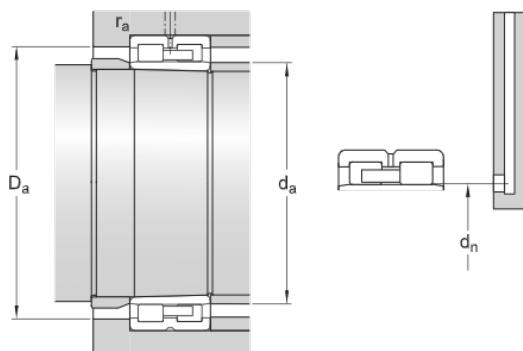
$d_a$  min. 271 mm Durchmesser der Wellenanlauffläche
