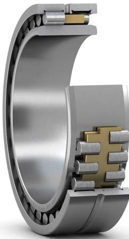
Zweireihiges Zylinderrollenlager der Reihe „Super-Precision“, Ausführung NNU, mit kegeliger Bohrung und Nachschmierfunktion
